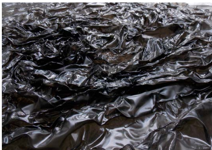
Figura 7. Quemaduras con soplete de gas sobre hule.
